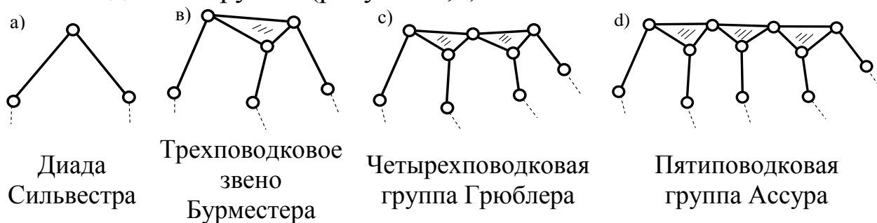
Рисунок 3 – Нормальные по Ассуру группы звеньев нулевой подвижности
