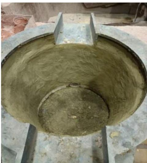
Рис. 2. Нанесенная защитная обмазка на основе молотого боя шамота [5]
