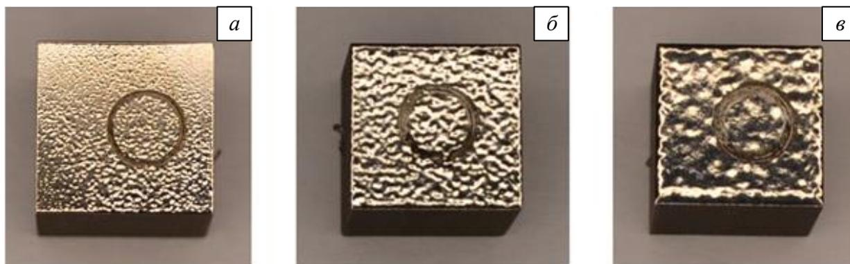
Рис. 3. Внешний вид образцов, подвергнутых облучению интенсивным электронным пучком после трибологических испытаний:
