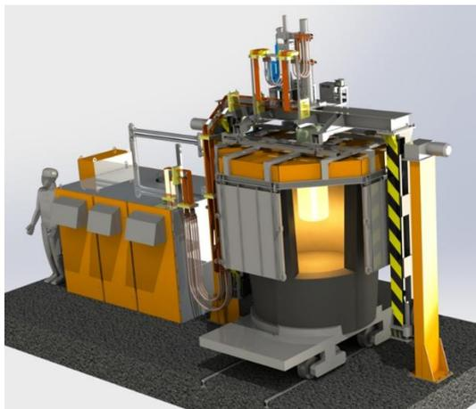
Рис. 6. Плазменная система для сушки и разогрева ковшей ЭПОС-НП-2 [24]
