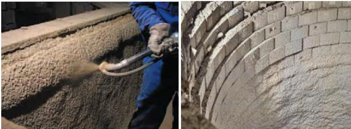
Рис. 1. Торкретирование разливочных ковшей [5]
