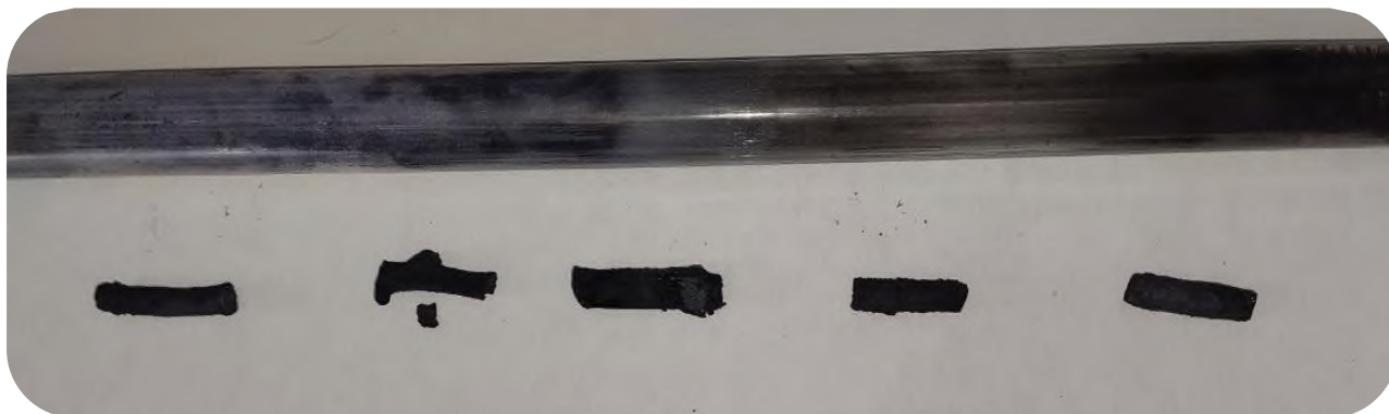
Рисунок 1. Возможный вид биочара, получаемый из древесных отходов с помощью пиролиза при 700°C без доступа кислорода.
