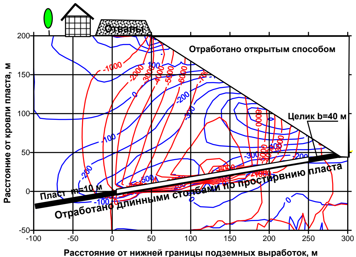
Рисунок 3. Графики сдвижения (мм) массива горных пород под влиянием выработанного пространства угольного пласта, отработанного длинным столбом по простиранию с обрушением пород кровли в приконтурной зоне угольного разреза: красный цвет – вертикальные смещения; синий цвет – горизонтальные смещения.
