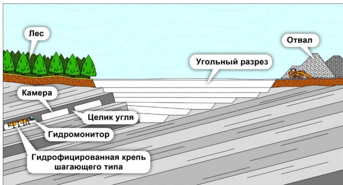
Рисунок 2. Отработка трудноизвлекаемых запасов угля короткими забоями с применением высоконапорной гидроотбойки.
