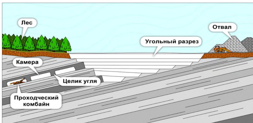
Рисунок 1. Классическая схема проведения камер и извлечения междуканнерных целиков при камерно-столбовой системе разработки.
